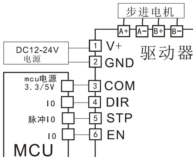
MCU(单片机)只能按共阳极解法，驱动器 COM 接单片机电源，则单片机 IO 口可以直接接到驱动器信号，注意 IO 输出电流之和不能超过单片机的本身的参数。单片机 IO 输出也可通过缓冲器接到驱动器，对应 COM 接到缓冲器的电源上。
