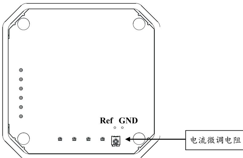
电机在不转动情况下，调节相电流，左图所示调节电位器，测量 GND 和 Ref 之间电压。
